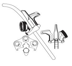
PORTAACCESORIOS (TUBOS): El portaaccesorios está formado por una sola pieza que contiene el cepillo para el polvo, la boquilla para las tapicerías y la boquilla para rendijas. Se monta sobre la parte delantera del motor encajándolo en las muescas que se encuentran en ambos de lados de la receptáculo (véase ilustración). Presione hacia abajo y coloque el portaaccesorios en su sitio. Pulse el botón de fijación para sacar los accesorios.
