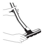
8 Regule el flujo de aire con el manguito regulador que se encuentra en la parte superior del tubo curvado. Para obtener la potencia de aspiración máxima cierre la apertura con el manguito regulador.
