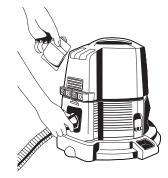
**ROCIADOR:** El Dispositivo Rociador de Rainbow se fija a los tubos del Rainbow y se usa para rociar insecticidas, soluciones contra pollillas, etc. También puede usarse con fertilizantes líquidos o con agua para sus plantas domésticas. Para usar el Rociador, simplemente colóquelo en el tubo de mango curvo y conéctelo a la manguera de escape de aire de su Rainbow.
